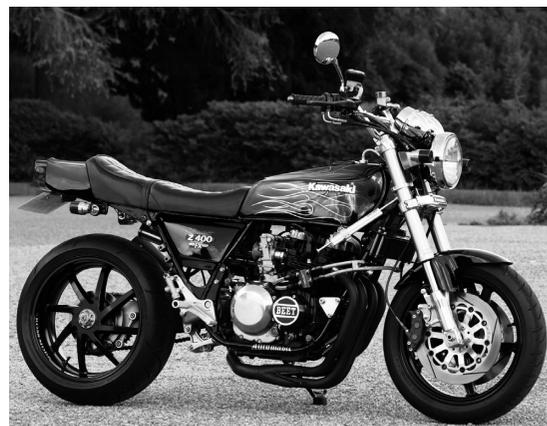
なぜZ400FXにプロアーム?という疑問はナンセンス。オーナーの「こうした」という希望を聞きつつ、ちゃんと走るようにまとめるのがカスタムシヨップの腕の見せ所である。このFXはスイングアームピボットの幅を大幅に広げて、200mmのタイヤセンターがフレームセンターと合致するようにホンダRC45のスイングアームをセットしてある。純正カウンタースhaftの先端から遠く離れたオフセットスプロケットの振れを抑制するため、スプロケットカバー側にも軸受けを設けたアウターボードを取り付けている。
