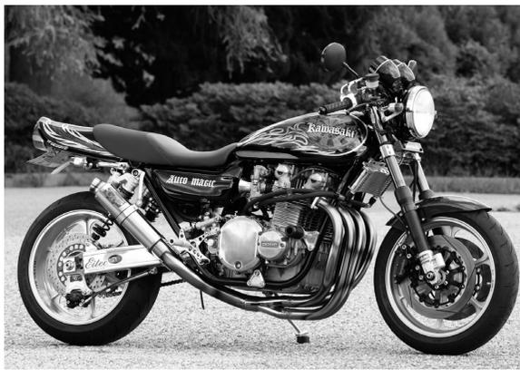
Z1のフレームをベースに、ダウンチューブからスイングアームピボット上までを新作したユニットDFCカスタム。純正フレームのデザインを踏襲しながらスイングアームピボットの幅を260mmまで拡張して、ピボット幅の広いスイングアームとリアタイヤをセットするための23mmオフセットスプロケットを装着しても、フレーム内側のザグリ無しでチェーンラインを確保している。左側ダウンチューブの溶接エンジンマウントを別体タイプとすることで、エンジン搭載位置も変えられるようになっているのがポイント。
