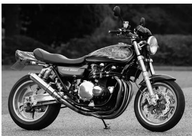
腐食したフレーム、太いタイヤを入れられないフレームが抱える問題を一掃するユニットDFCフレーム。フレームを切つたという拒否反応を示すシヨップやユーザーが少なくないが、カスタムの手法として自信と実績のある手法である。
