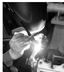
フレームを切断して溶接するには、熱によるゆがみや強度変化に対する深いノウハウが必要だ。ジグでガッチリ押さえつつ、歪みを逃がすように溶接を行うことでピンポイントで通ったフレームが完成する。
