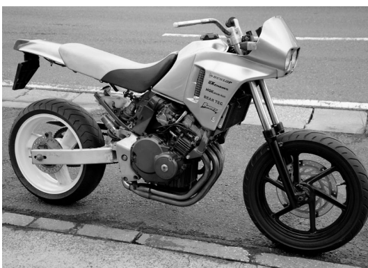
DFCはビッグバイクだけのものではない。お客さんからのオーダーで製作しているのはホンダAX-1とホーネットを合体させたDFCである。オフモデルがモタード的なオンロード寄りにカスタムされるのはあるが、4気筒のオンロードモデルがオフ風になるのが斬新だ。
