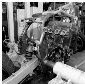
DFCニンジャと並んでオーダーが多いDFCカタナ。これはGSX750SカタナとGSF750/1200フレームの下半分と組み合わせている途中の車両。ヘッドパイプ周辺の溶接を変更せず、2分の1以上の基本骨格を残すという陸運局の解釈に従いつつ、カタナのディメンションをもっとスポーティに変更する。ディメンションを自由に設定できるのがDFCの大きな利点である。
