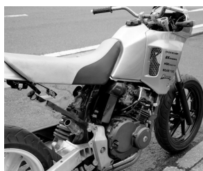
DFCはビッグバイクだけのものではない。お客さんからのオーダーで製作しているのはホンダAX-1とホーネットを合体させたDFCである。オフモデルがモタード的なオンロード寄りにカスタムされるのはあるが、4気筒のオンロードモデルがオフ風になるのが斬新だ。
