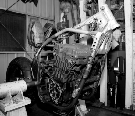
DFCニンジャと並んでオーダーが多いDFCカタナ。これはGSX750SカタナとGSF750/1200フレームの下半分と組み合わせている途中の車両。ヘッドパイプ周辺の溶接を変更せず、2分の1以上の基本骨格を残すという陸運局の解釈に従いつつ、カタナのディメンションをもっとスポーティに変更する。ディメンションを自由に設定できるのがDFCの大きな利点である。
