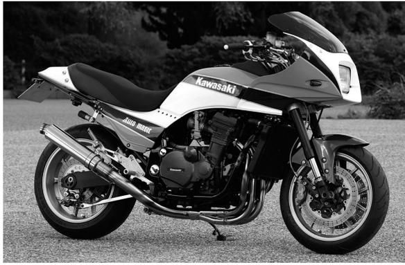
空冷エンジン最終モデルのGPZ1000F用フレームの上半分と、水冷GPZ1000のフレーム下半分を合体させたDFCの最新作。見ると正体不明だが、フレームナンバーから機種名は空冷GPZ1000Fとなる。
