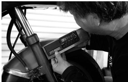
車体を水平にして、前後タイヤへの荷重を抜いた状態でキャスト角を測定すると、スベックどおり29度という数字が出た。ライダーがまたがってフォークを沈めれば角度が立つが、この測定では荷重を抜いて比較する。
