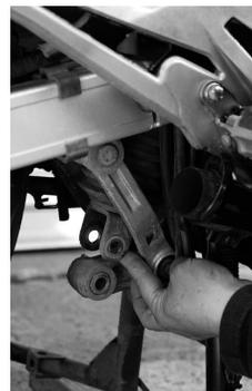
スイングアーム垂れ角を5度増すには、リアサスを伸び切り状態にしてもまだ足りず、リアショックとリンクを切り離さなくてはならない。この隙間を埋めるため、リンクロッドを短縮するか、車高調整付きのリアショックを装着しなくてはならない。それでもリンクの位置関係は大きく変化して、作動性は純正設計時とは異なってしまう。
