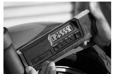
センタースタンド下に材木を挟んで前下がりの状態を作り、フロントフォークの角度を25.5度まで立てた。このページのメインカットが、その時の車体全体のスタイリングだ。フロント17イン치의車高なら、多くのニンジャユーザーがイメージしやすいかもしれないが、16インチ車でも前下がり、ケツ上がりのスタイルが分かるだろう。
