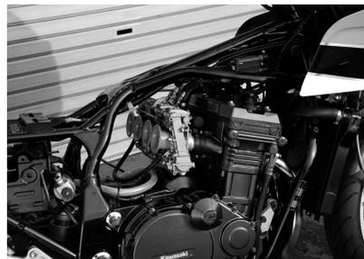
エンジンを含むダウンチューブの途中からスイングアームピボット、リアサスマウントを水冷GPZ用から切り取り、その部分はワンユニットとして路面に対して純正値を維持。その上に空冷GPZ用フレームの上半分を溶接し、キャスト角は水冷GPZの260度まで立ててある。右側ダウンチューブは水冷GPZと同様に着脱式としてメンテナンス性を向上。
