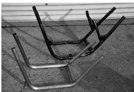
異なる機種のフレームを合体するだけでなく、クロモリパイプで新造した部品を用いてフレームをモディファイするユニットDFCも、オートマジックならではの手法である。ダウンチューブからスイングアームピボットを経て、シートレールに至る部分をオートマジック生産のユニットフレームとして新作することで、パイプ内部の腐食による強度不足や、ワイドスイングアームを装着する際にも、チェーン軌道を確保するために無理なザグリをする必要はない。
