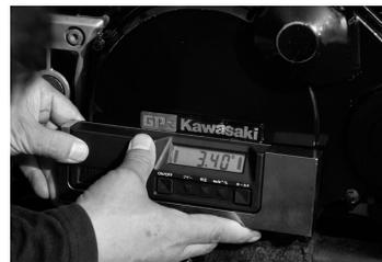
フロントフォークを3.5度立てることで、クランクケースも3.4度前下がりになった。前輪の接地面を基準にして車体が前転方向に回っていることを示している。
