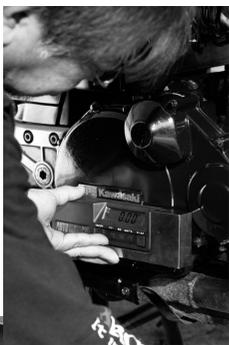
この車体姿勢におけるスイングアームの垂れ角は8.10度だった。リアショックがへたって沈み込みが増えると、スイングアームが水平に近づき、キャスト角はさらに寝る方向になる。
