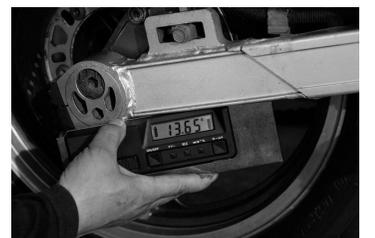
フロントフォークとクランクケース(エンジン)の前傾具合が同じ傾向にあるのに、スイングアームの垂れ角は純正キャスト角時の8.10度に対して13.65度に増加している。5度の違いはバツと見ても明らかだ。
