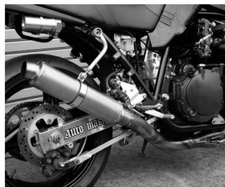
エンジンハンガーとモノショックのアップマウント部を一体化したモノサスマウントは、エンジン長短縮化によって実現した機構である。このハンガーに十分な強度を持たせたことで、純正フレームのスイングアームピボット周辺の剛性向上にも効果を発揮する。
