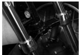
正面衝突のような状況で衝撃を受けた時、この手の鉄製ブラケットは簡単にねじれ、場合によっては後方に押し込まれてオフセットが減少するように変形するもの、簡単に修正できてしまう。一方、アルミ製ブラケットは一度変形すると修正できないほど硬く、これがフロント周りの剛性感向上に寄与した。
