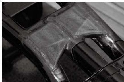
バックボーンに追加したプレートは、ステムパイプ上側のフレームに加わる衝撃を受け止める。プレートのサイズによって応力の影響範囲が変化するため、機種や使用目的によって補強は変化する。
