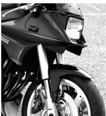
オートマジックはGSX1100Sカタナに油冷GSXR1100の足周りやエンジンをコンパートするカスタムの先駆者だ。純正に対して太いタイヤや強固な倒立フォークを装着することでフレームへのストレスを心配しなくなるが、エンジンが軽くなることでフレームの負担はむしろ軽減され、パワーウエイトレシオも改善する利点がある。
