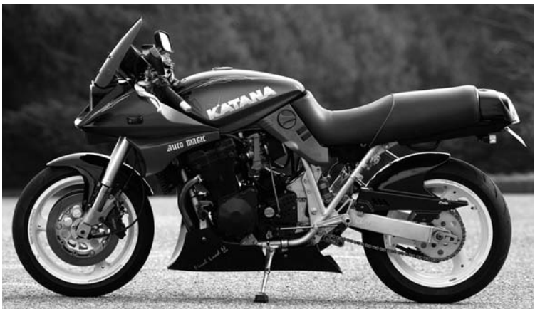
オートマジックはGSX1100Sカタナに油冷GSXR1100の足周りやエンジンをコンパートするカスタムの先駆者だ。純正に対して太いタイヤや強固な倒立フォークを装着することでフレームへのストレスを心配しなくなるが、エンジンが軽くなることでフレームの負担はむしろ軽減され、パワーウエイトレシオも改善する利点がある。
