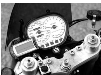
ラジアルタイヤ、4ポッドブレーキ、倒立フォークによって路面のグリップ力、ブレーキパフォーマンスはスタンダードより格段に向上するが、上下ステムがしっかり受け止めることで不規則な動きがなくなれば、乗り心地は俄然シャキッとす。
