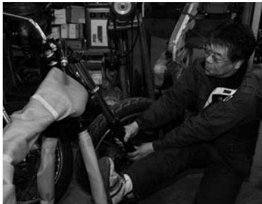
Z1からZ1000 Mk. IIまで、アンダーブラケットの材質はずっと鉄。これは、フレームを押し込めてフォークを引っ張るだけで変形が感じられるほど軟らかく、ハイグリップタイヤを装着するところの変形でショックを吸収し、不安定な挙動を作り出してしまう。
