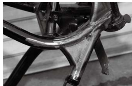
ニンジャの純正フレームにはないダウンチューブの接合部には、ステムに加わった衝撃をバックボーンとダウンチューブに効果的に分散するため、ボックス構造のガセットプレートが付加している。
