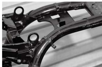
バックボーンからピボット部に向かうカーブも、力の分散にとって重要な部分だ。ここに補強を当てる時は、元のフレームのアーチと、ガセットのアーチをどのように設定するかなど、留意すべきポイントはたくさんある。
