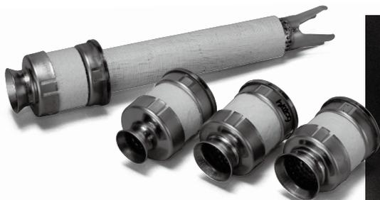
DFCとともにオートマジックが特許を取得しているのがインナーバフルである。これはテールパイプとサイレンサーの間に装着する付加物はすべて特許申請の範疇に含まれる。バフルによって消音、トルク特性の変更など複数の効果が期待でき、マフラーの外観を変えることなくチューニングが可能になるのが特徴だ。発明の名称は「排気構造」と、DFC同様シンプルだ。
