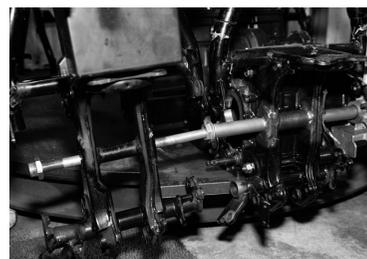
ダイヤモンドフレームニンジャで他のショップにないカスタムを追求するオートマジックでは、スイングアームピボットに注目。どれだけ凄いスペシャルスイングアームでもピボットシャフトは純正のφ16mmのままであることがほとんどで、太いタイヤや剛性の高いスイングアームのしわ寄せが来るのは確実。そこで要となる極太φ25mmのシャフトが使えるようピボット内径を拡大、周辺にも補強を加えていきます。見た目だけでなく、機能面や剛性面でも合理性を追求する。
