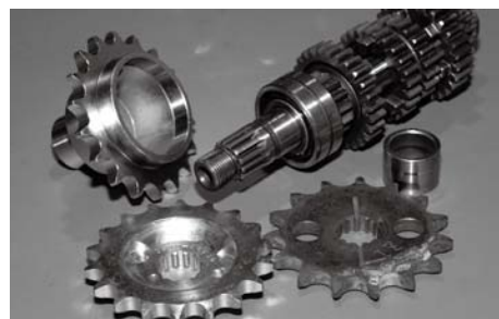
Z1用カウンターシャフトを中心に右から純正、530サイズの10mmオフセットスプロケット、実用新案を取得したボス付きオフセットスプロケット。太いリアタイヤを装着できるのはこの商品のおかげ。20年間売れ続けている大ヒット商品だ。
