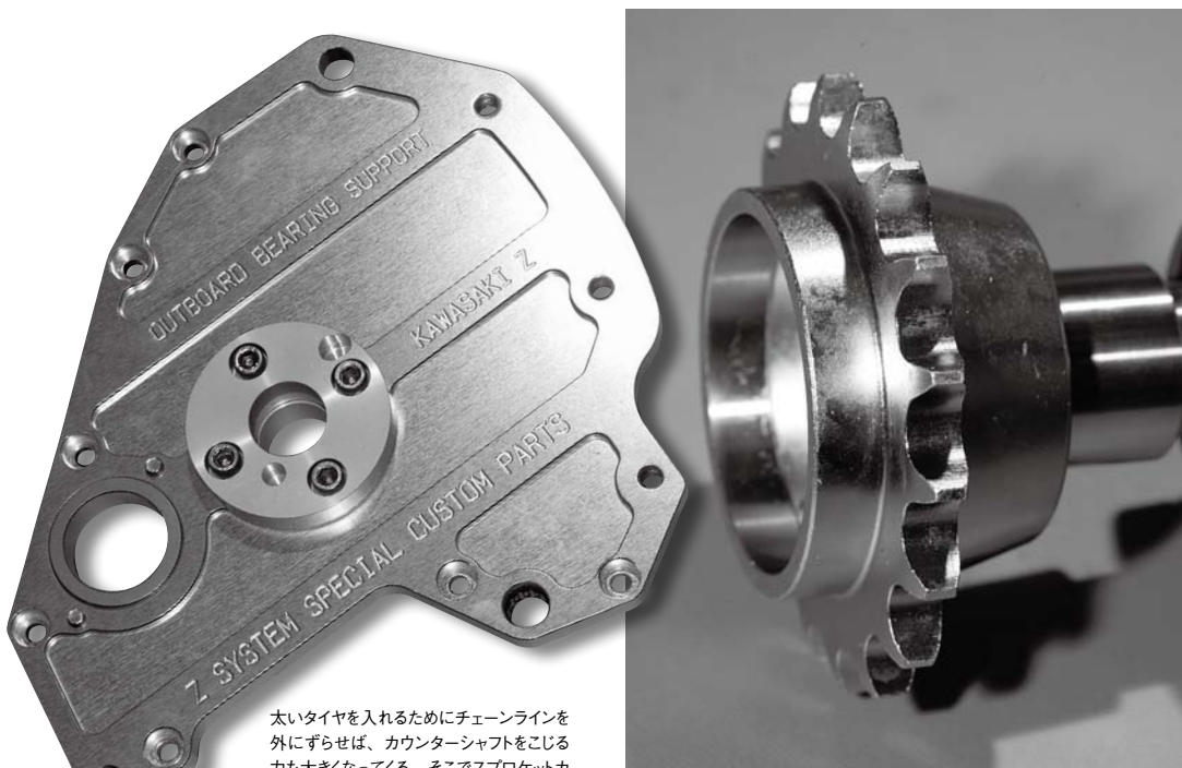
純正スプロケットや通常のオフセットスプロケットは、スプロケの裏側にカラーが入っている。そのカラーをスプロケットと一体にして、カウンターシャフトとはめ合い長さを稼ぎ、オフセット量増加による傾きを防ぐのがボス付きオフセットスプロケットの狙い。
