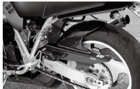
バイクブーム時代のレーサーレプリカ車は、1970年代から80年代の絶版車をカスタムする際に絶好のネタとなった。ショップや個人がマシンを製作する時にネックとなるチェーンライン調整が、オフセットスプロケットの登場で一気に容易になった。
